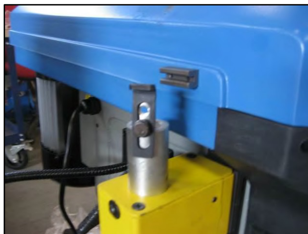
Фигура 38 - Регулиране на горния предпазител
