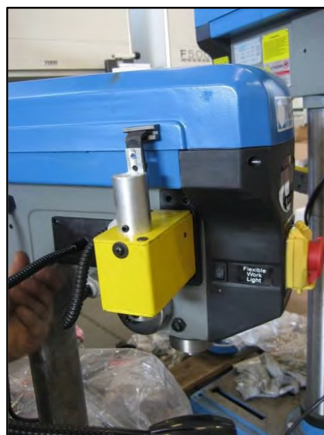
Фигура 36 - Превключвател за включване/изключване на лампата
