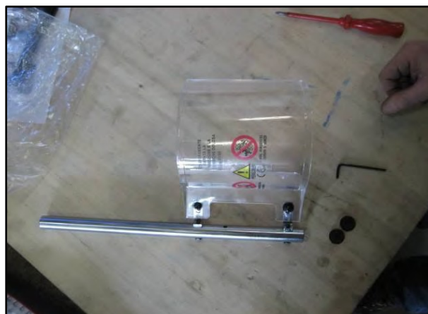
Фигура 42 – Опорен лост и предпазител
