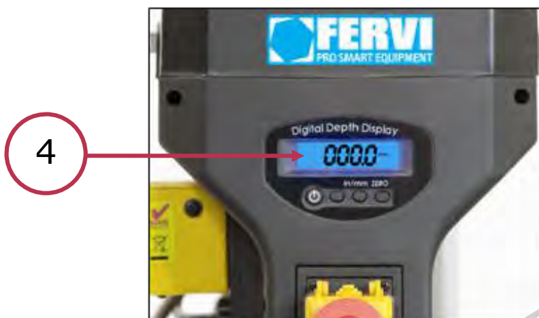
Фигура 7 - Индикация за спускане на шпиндела
