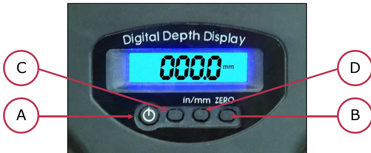
Фигура 8 - Визуализация за спускане на шпиндела
