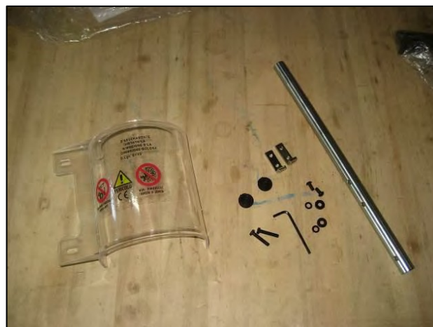
Фигура 39 - Части за монтиране на предпазителя
