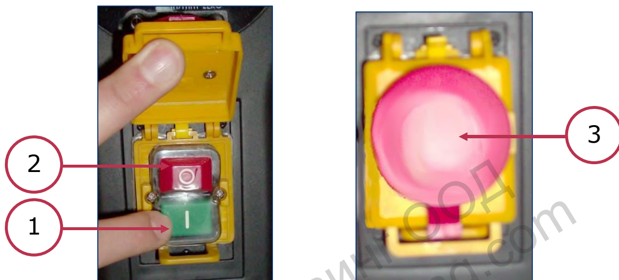
Фигура 6 - Бутон за старт/стоп и бутон за аварийно спиране
