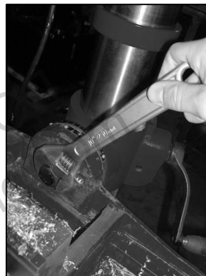
Фигура 21 - Болт за накланяне на работната повърхност
