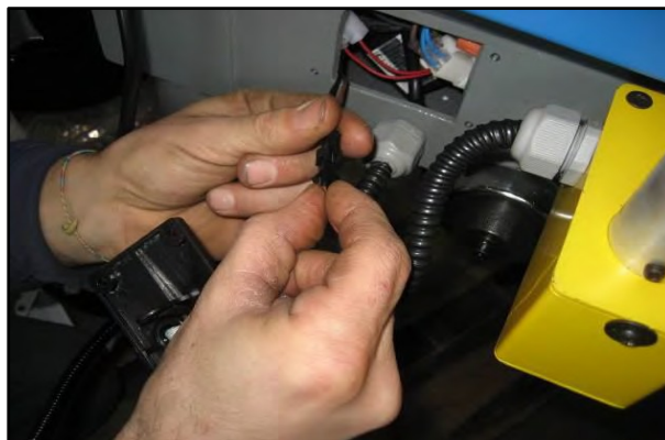
Фигура 34 - Свързване на захранващ кабел
