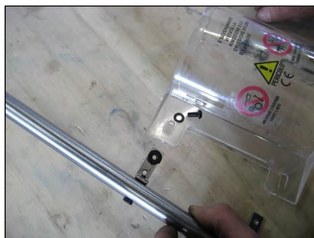
Фигура 41 - Монтаж на предпазителя
