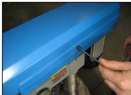
Фигура 9 - Винт на предпазителя
